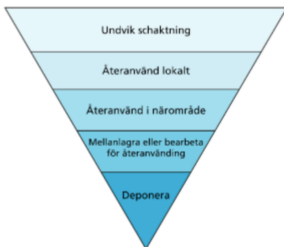
Figur 2. Masshanteringshierarki och prioriteringsordning som ska vara styrande för all hantering av massor inom kommunal förvaltning, Gävle kommun.
